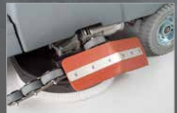
jupes latérales pour faciliter lever et baisser
